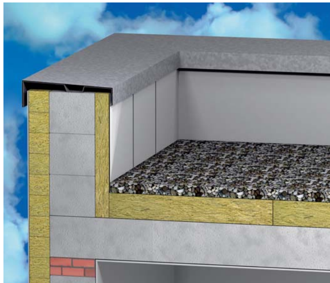
WIZ. 226.4. Warstwa balastowa ze żwiru płukanego na pokryciu dachowym.
