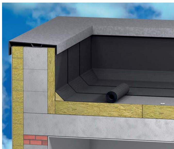
WIZ. 223.4. Zgrzewanie papy nawierzchniowej do papy podkładowej.
