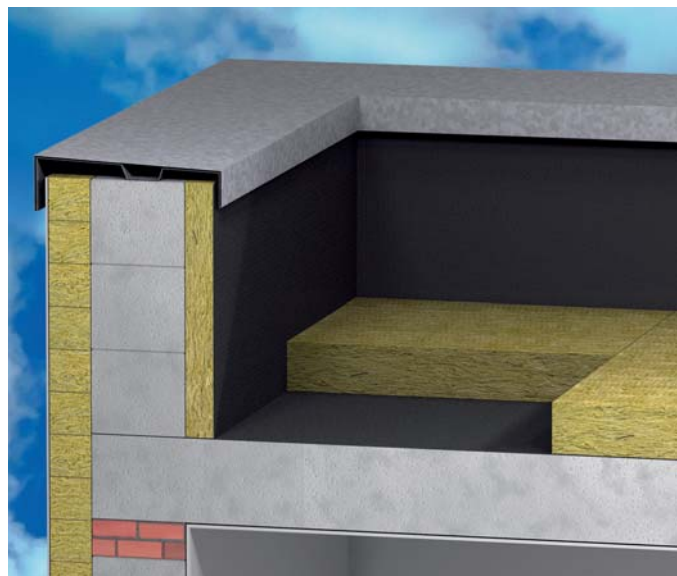
WIZ. 224.2. Płyty MONROCK PRO przyklejane do podłoża klejem bitumicznym na zimno.
