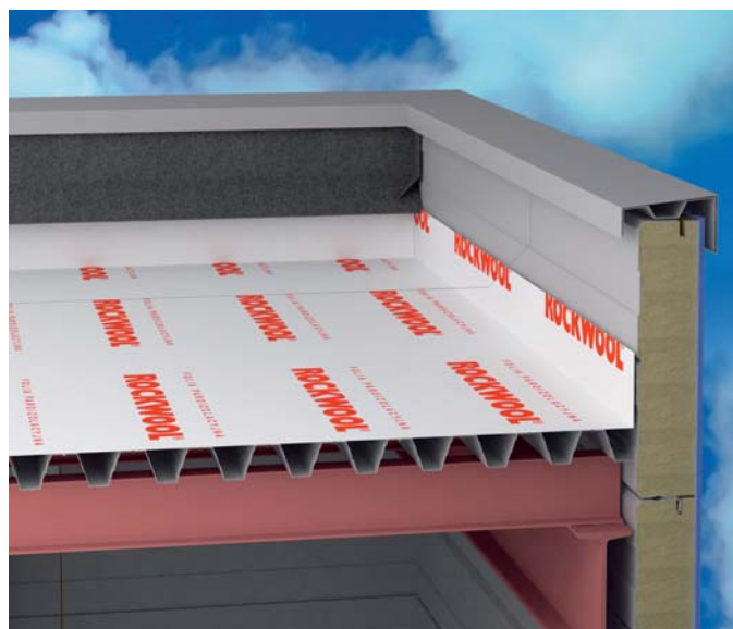
WIZ. 221.1. Układanie Foliai paroizolacyjnej ROCKWOOL na blasze trapezowej.
