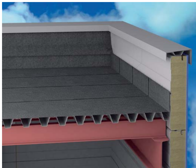
WIZ. 222.1. Papa paroizolacyjna zgrzewana do blachy trapezowej.
