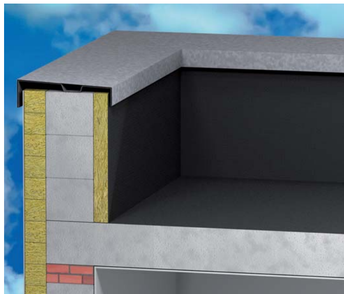
WIZ. 226.1. Zgrzewamy papę podkładową jako paroizolację do zagruntowanego podłoża betonowego.
