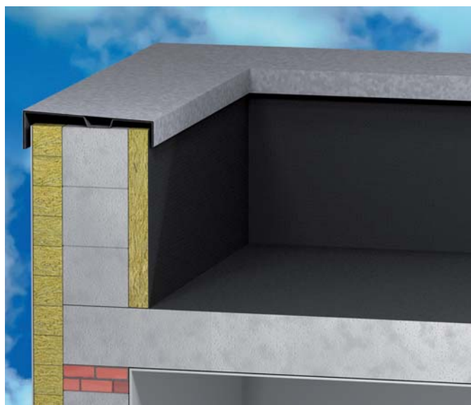
WIZ. 224.1. Strop betonowy zagruntowany dwukrotnie preparatem bitumicznym (jako paroizolacja).
