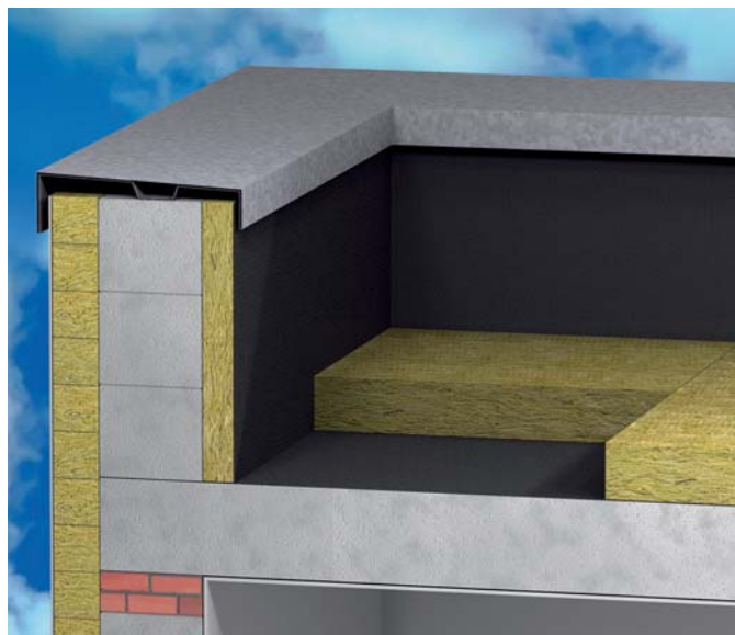
WIZ. 226.2. Układanie płyt DACHROCK MAX na sucho.
