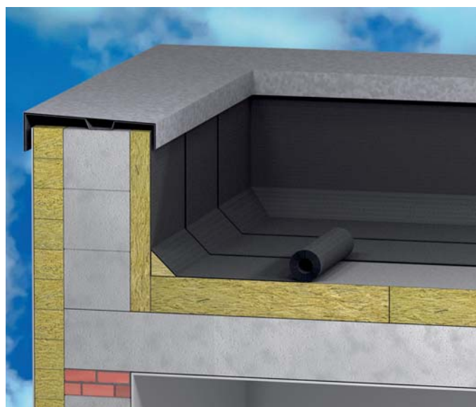
WIZ. 224.4. Papa nawierzchniowa zgrzewana do papy podkładowej.
