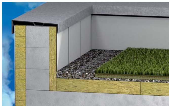
WIZ. 227.4. Układanie warstw zielonego dachu na pokryciu dachowym.
