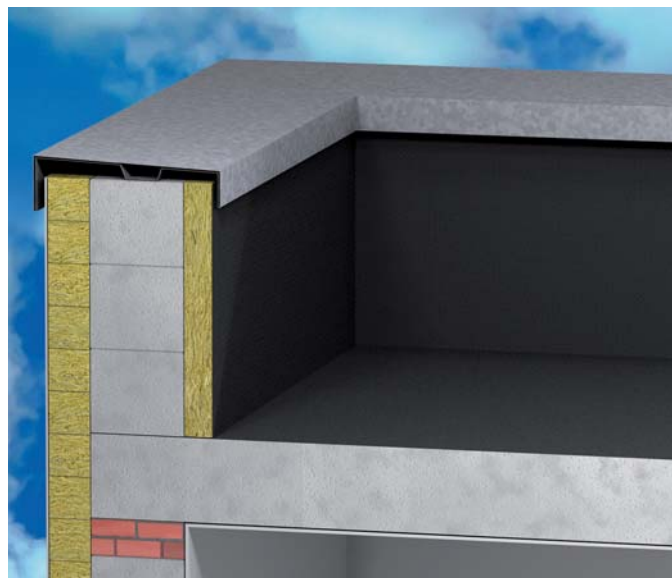
WIZ. 223.1. Papa podkładowa jako paroizolacja przygrzana do zagruntowanego podłoża betonowego.
