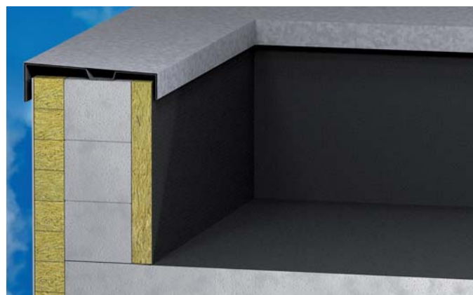
WIZ. 227.1. Papa podkładowa jako paroizolacja zgrzana do zagruntowanego podłoża betonowego.
