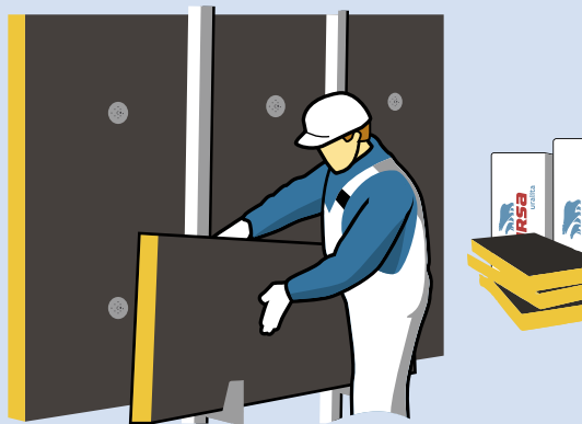
Rysunek 1 – Izolacja fasady wentylowanej metodą lekką-suchą
