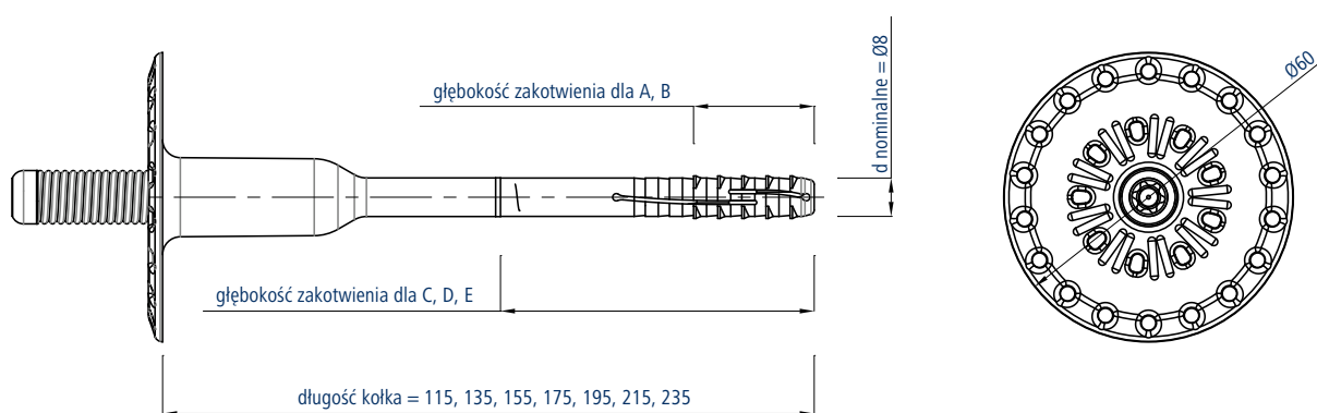
Rysunek 7 – Wymiary i strefy pracy kołka montażowego TFIX8S firmy KOLENER S. A.
